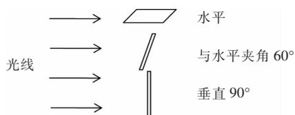
图 1 消毒机器人不同照射角度示意图
