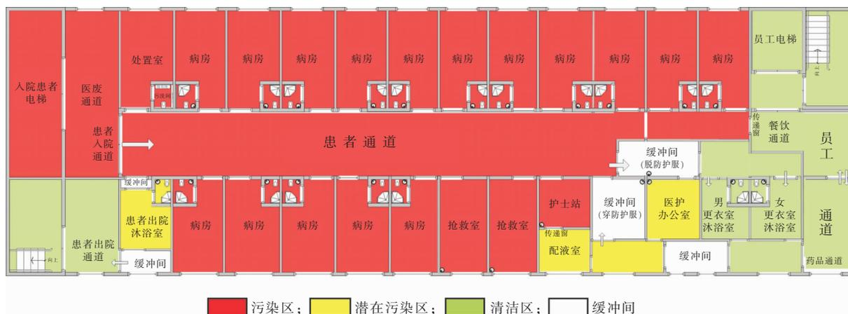
图 4 第二类结构病区改造后布局示意图
